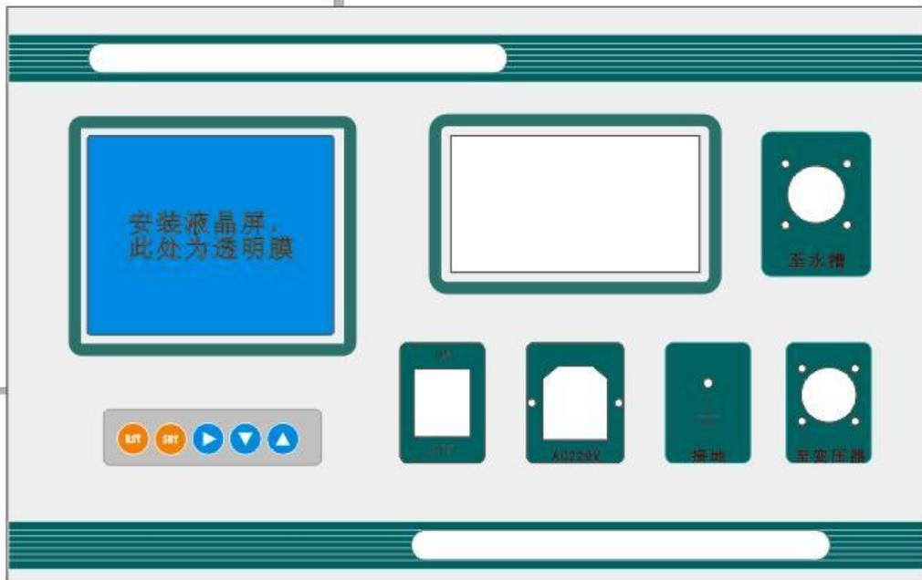
图 3-1 绝缘靴（手套）操作箱
