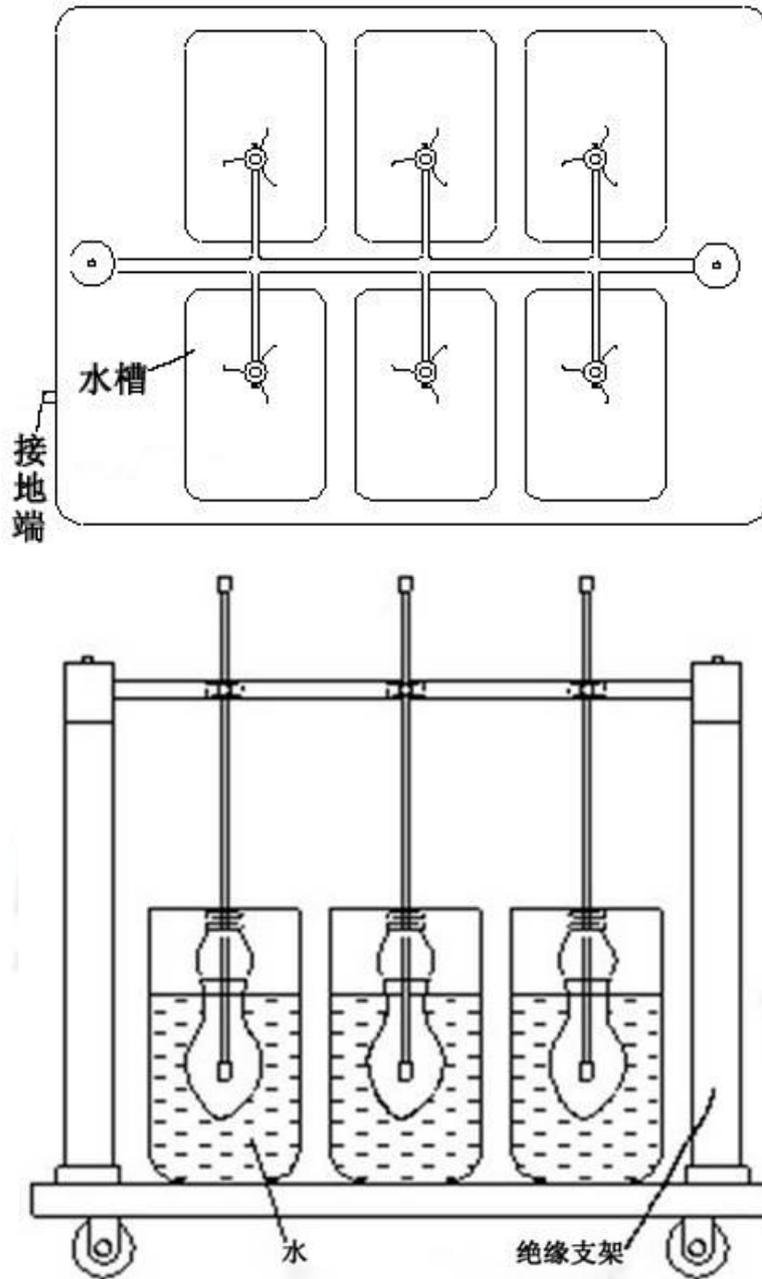
图 3-2 绝缘靴（手套）试验台
